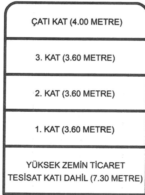
Şekil 4. Mevcut İnşaat Kat Yüksekliği Analizi.
